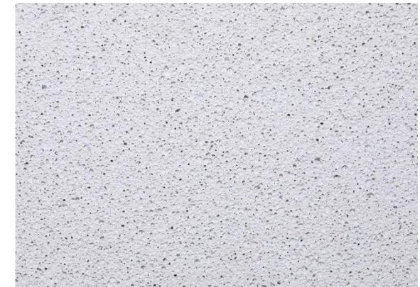
Abbildungen: Porenbetonstein / Porenstruktur<sup>1</sup>
