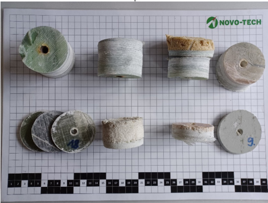
Probenahme Bauteil Rotorblatt
